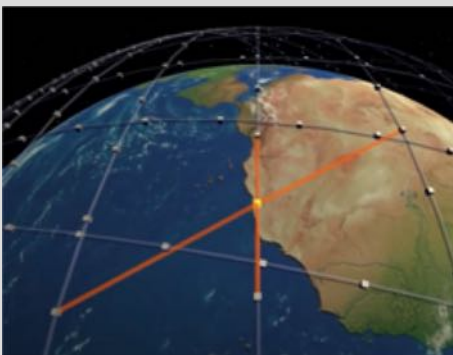
Starlink (SpaceXのサイトより) 上の例では隣接する4衛星と光ISLを設定。衛星間の距離は数十km程度と比較的短い。
