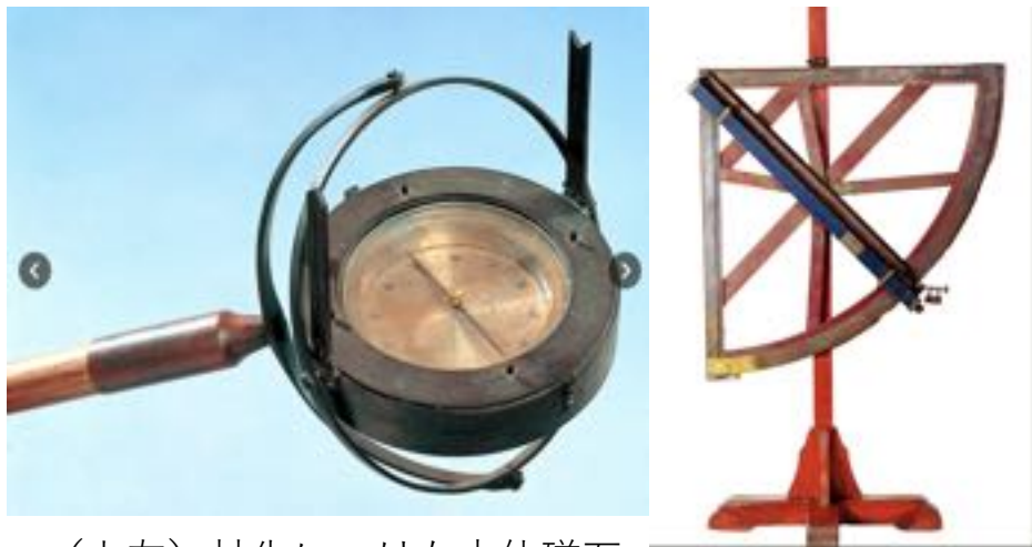
(上左) 杖先につけた方位磁石 (上右) 天体測定器具
